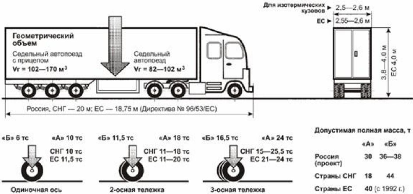
Рис. 5.11. Габариты и допустимые осевые нагрузки, полные массы автомобильных транспортных средств
